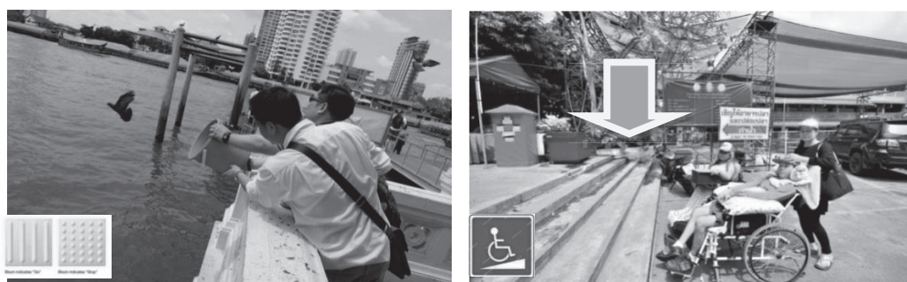
รูปที่ 12 แสดงอุปสรรคในการเข้าใช้พื้นที่ภายในวัดยานนาวาบนซ้าย แสดงพื้นที่บริเวณทำน้ำไม่มีพื้นผิวต่างสัมผัสสำหรับคน พิการทางสายตาบนขวา แสดงพื้นที่บริเวณทางขึ้นทำน้ำไม่มีทางลาดสำหรับรถเข็นคนพิการ ที่มา: ผู้วิจัย (2562)
