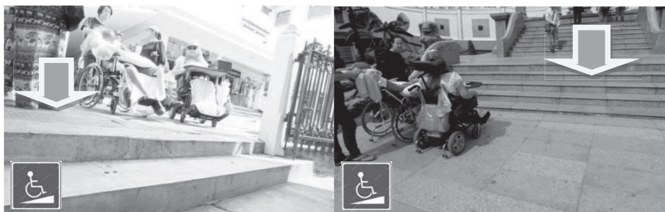
รูปที่ 10 แสดงอุปสรรคในการเข้าใช้พื้นที่ภายในวัดยานนาวา บนซ้าย แสดงพื้นที่บริเวณทางเข้าเจดีย์เรือสำเภา ไม่มีทางลาดสำหรับรถเข็นคนพิการ บนขวา แสดงพื้นที่บริเวณพระอนุสาวรีย์สมเด็จพระนั่งเกล้าฯ ไม่มีทางลาดสำหรับรถเข็นคนพิการ ที่มา: ผู้วิจัย (2562)
