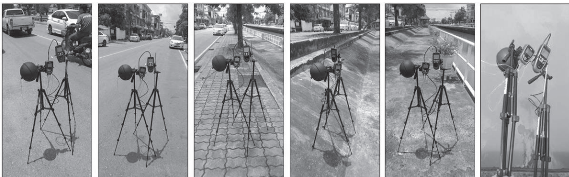
รูปที่ 3.1 แสดงการเก็บข้อมูลอุณหภูมิอากาศ (Air Temperature) ความเร็วลม (Wind Speed) และอุณหภูมิ Globe thermometer ตามจุดสังเกต 6 จุด เวลา 07.00-19.00 น. วันที่ 6-10 พฤษภาคม 2562
