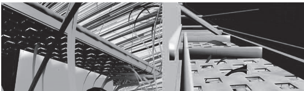
รูปที่ 2 รูปแสดงภาพลมที่ตีกลับและดันเข้าสู่ช่องระบายอากาศของผ้าชายคา ที่มา: ผู้วิจัย (2563)
