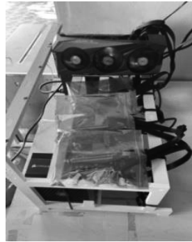
รูปที่ 6.1 เตรียมอุปกรณ์และประกอบ Rig 1 Unit (ประกอบด้วยการ์ด GPU.1 หน่วย, Riser, Mainboard, PSU.) ที่มา: ผู้วิจัย (2565)
