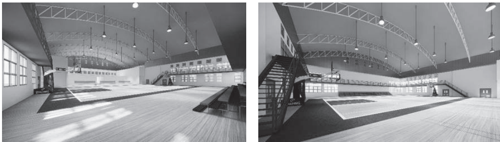
รูปที่ 13 ภาพการจำลองการติดตั้งพัดลมระบายอากาศของสนามกีฬาในร่ม วชิราวุธวิทยาลัย ที่มา: ผู้วิจัย (2569)
