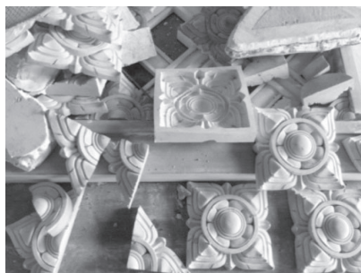
รูปที่ 1 แสดงรูปชิ้นงานประจายาม หล่อด้วยแบบหล่อซิลิโคน ประจายามโบสถ์วัดสวนสันติธรรม จังหวัดชลบุรี ที่มา: ผู้วิจัย (2560)
